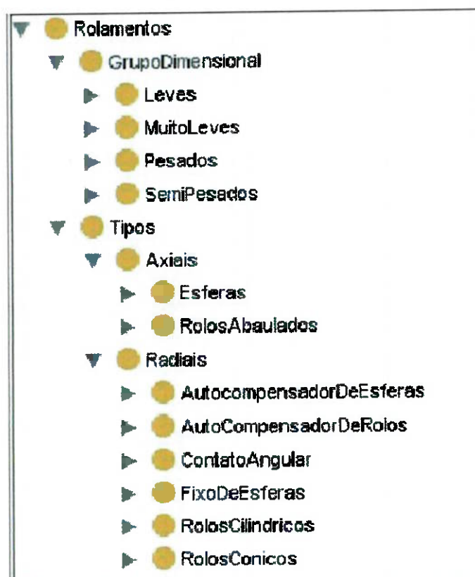
Figura 11.2 Estrutura de Classes de características de Rolamentos
